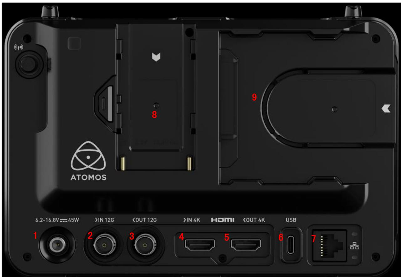
機身背面下方從左到右依序為：1. 電源輸入、2. SDI輸入、3. SDI輸出、4. HDMI輸入、5.HDMI 輸出、6. USB-C接口、7. 網路線孔。上方則是：8. 電池/假電插槽、9. SSD卡插槽。
